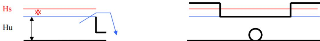
Le dispositif de rétention doit disposer d'une hauteur d'eau supplémentaire  $H_s$  au-delà de  $H_u$  pour permettre à la surverse d'évacuer le débit supérieur au degré de protection de l'ouvrage (ici de  $T=100$  ans).
